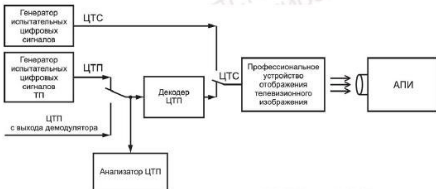
Рисунок 9 — Схема измерения характеристик и параметров тракта воспроизведения цифровых сигналов высокой четкости
