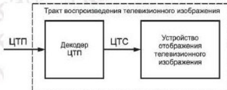
Рисунок 8 — Структура тракта воспроизведения цифровых телевизионных сигналов высокой четкости
