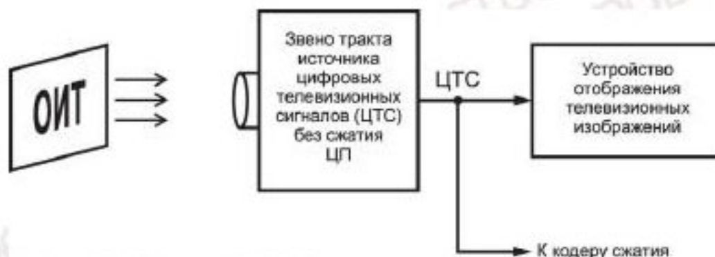
Рисунок 3 — Измерение параметров звена тракта источника цифровых телевизионных сигналов без сжатия цифрового потока
