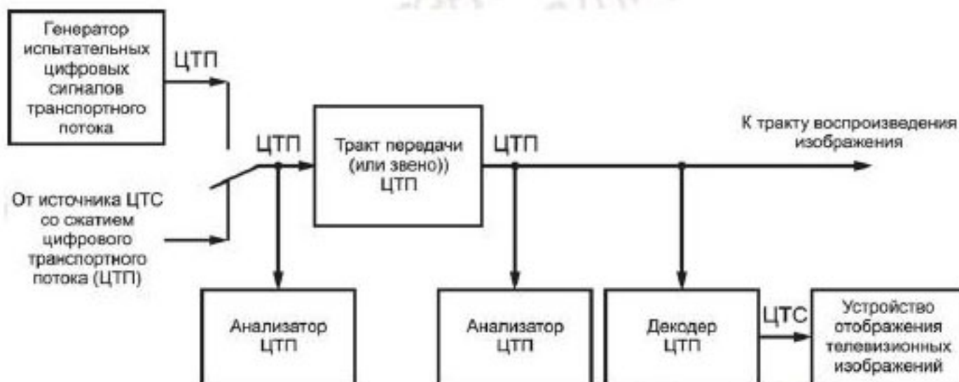
Рисунок 5 — Схема измерения параметров тракта передачи цифрового транспортного потока
