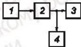
1 — резистор — эквивалент сопротивления источника; 2 — измеряемый тракт или звено; 3 — номинальное сопротивление нагрузки — резистор; 4 — псофометр
