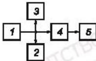
1 — низкочастотный генератор сигналов; 2 — селективный вольтметр; 3 — частотометр; 4 — канал звукового вещания;
