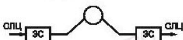
Рисунок 11 — Канал звукового вещания со спутниковой системой передачи
