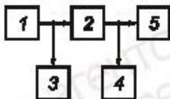
1 — низкочастотный генератор сигналов; 2 — измеряемое звено; 3, 4 — вольтметры;
