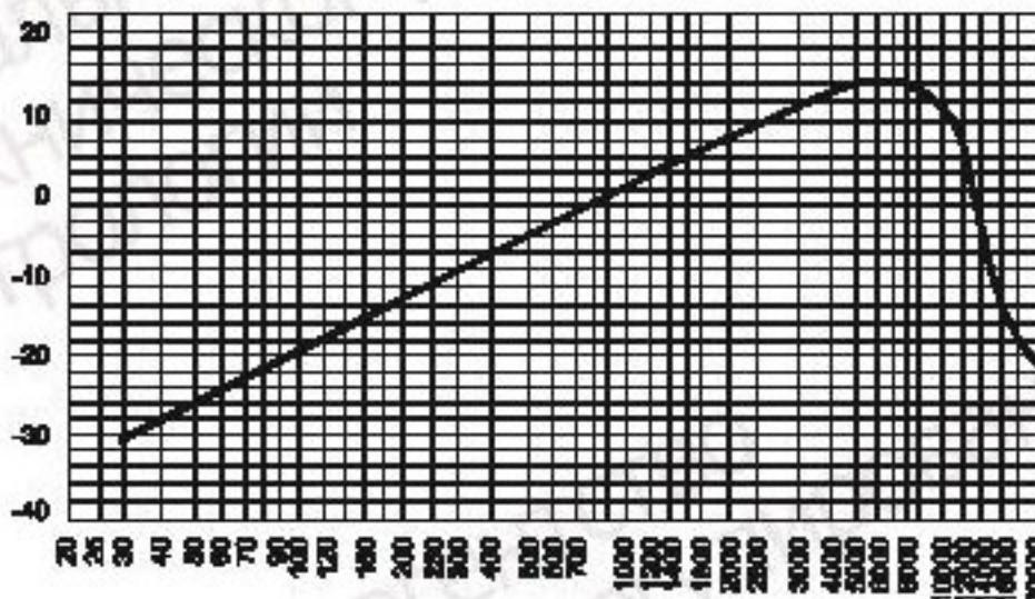
Рисунок 13 — График АЧХ псофометрического фильтра в соответствии с [4]
